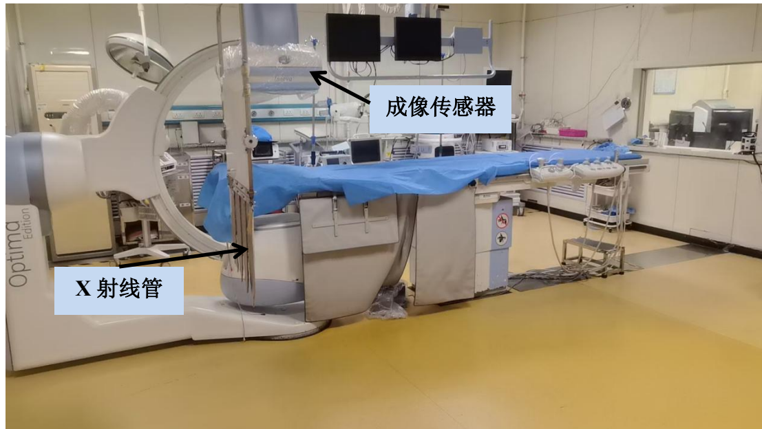
图 9-2 既有 GE Innova3100-IQ 型 DSA 外观图
