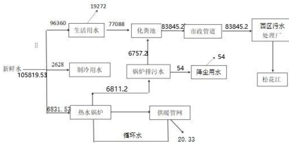
图 2-2 变动后全厂水量平衡图 (t/a)
