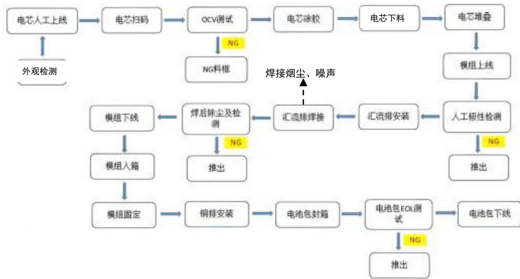
图 2-5 农用机械动力系统集成生产工艺流程及产污节点图
